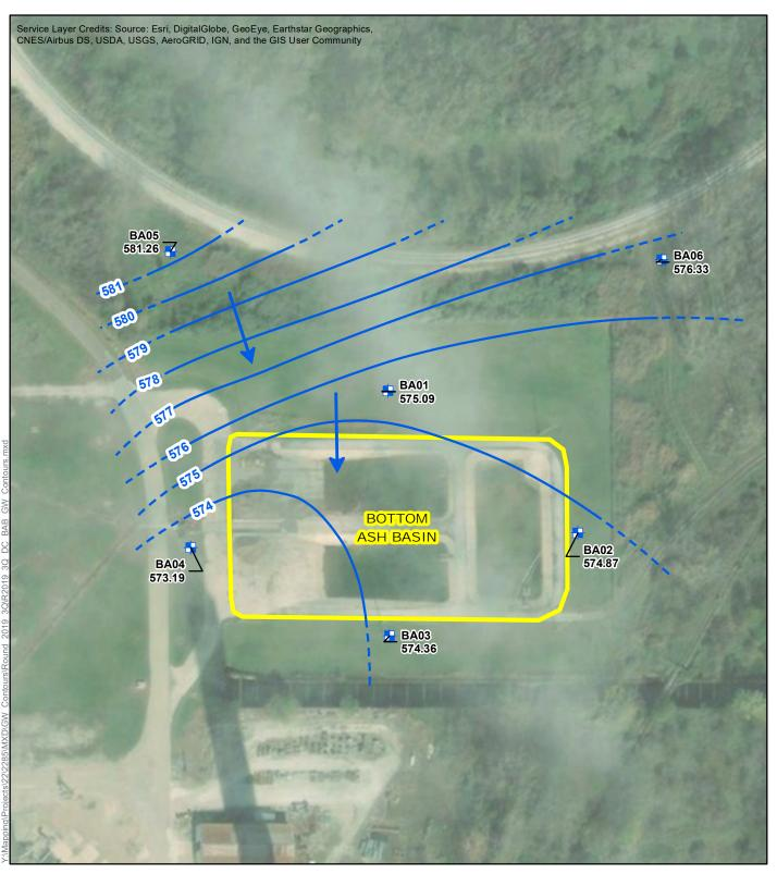
CCR RULE MONITORING WELL LOCATION GROUNDWATER ELEVATION CONTOUR (1-FT CONTOUR INTERVAL, NAVD88) INFERRED GROUNDWATER ELEVATION CONTOUR GROUNDWATER FLOW DIRECTION
